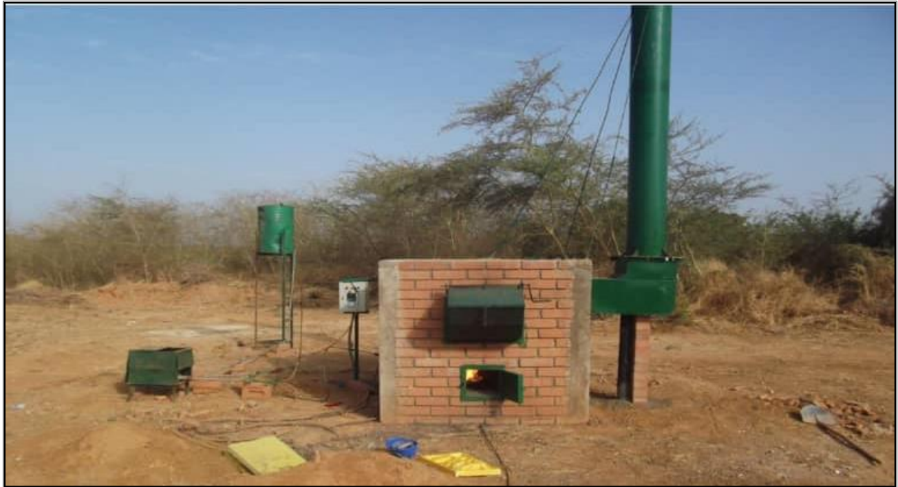
Photo 10 : Incinérateur modèle « Faso incinérateur »
