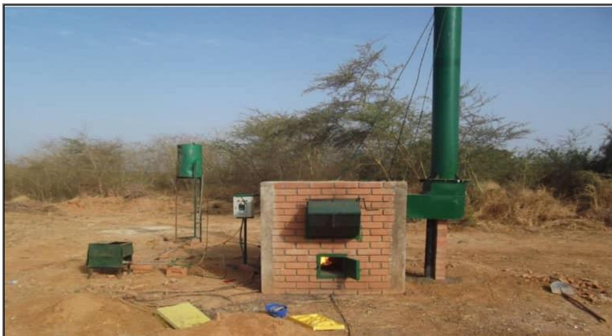
Photo 6 : Incinérateur modèle « Faso incinérateur »
