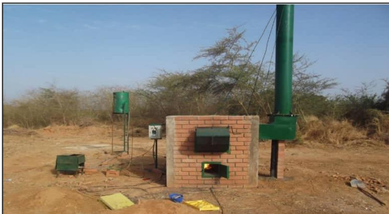
Photo 7 : Incinérateur modèle « Faso incinérateur »
